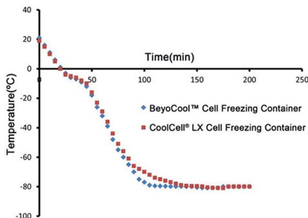
图1. -80°C冰箱中本产品放入细胞冻存管后管内的降温曲线图。图中可见碧云天的BeyoCool™细胞冻存盒和Corning®公司的同类产品CoolCell® LX Cell Freezing Container的降温效果相近甚至略优。实测数据会因实验条件、检测仪器等的不同而存在差异, 图中数据仅供参考。
